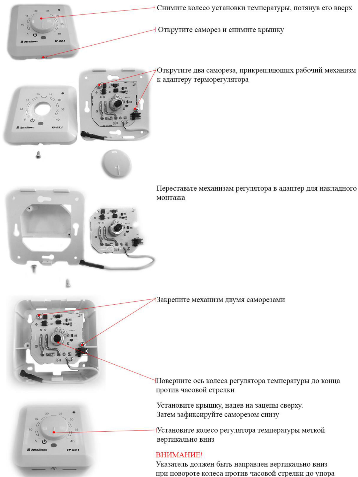
Рис. 10 – Замена адаптера терморегулятора Эрголайт TP-03
